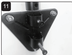
Igazítsa össze a falventilátor konzolt a háromszög alakú lemez lyukpozíciójával
