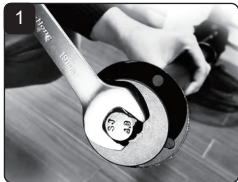
1 Verwijder de schroeven van de motor
