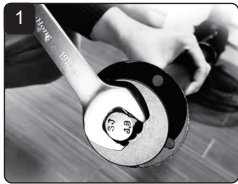
Зніміть гвинти з двигуна
