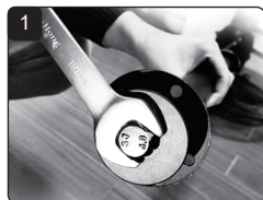
Снимите винты с мотора
