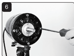
Установите заднюю крышку и затяните винты
