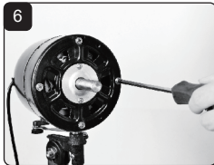
6 Instale a tampa traseira e aperte os parafusos
