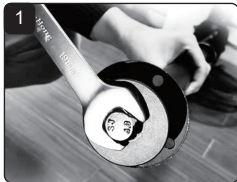
Uklonite šrafove sa motora
