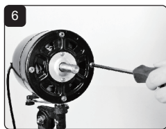
Ugradite stražnji poklopac i pričvrstite vijke
