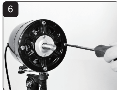
Instalirajte zadnji poklopac i zategnite šrafove
