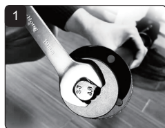
Uklonite vijke s motora
