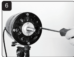
Installez le couvercle arrière et serrez les vis
