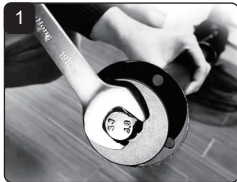
Entfernen Sie die Schrauben vom Motorgehäuse
