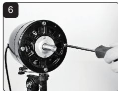
Встановіть задню кришку та закрутіть гвинти
