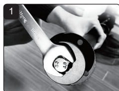
Odkręć śruby od silnika
