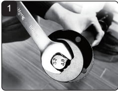
1 Scoateți șuruburile de pe motor
