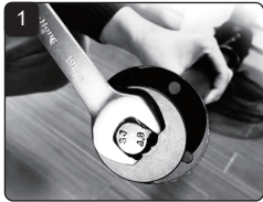
Retirez les vis du moteur
