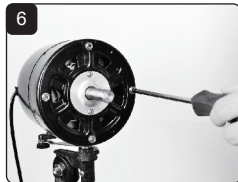
6 Installeer het achterste deksel en draai de schroeven vast
