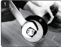
Távolítsa el a csavarokat a motor csavarjából
